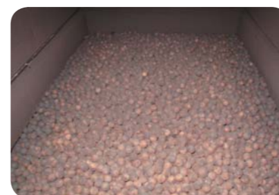
蓄热体小球 Regenerator granule
