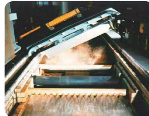
冷轧常化与酸洗联合机组集成布置
