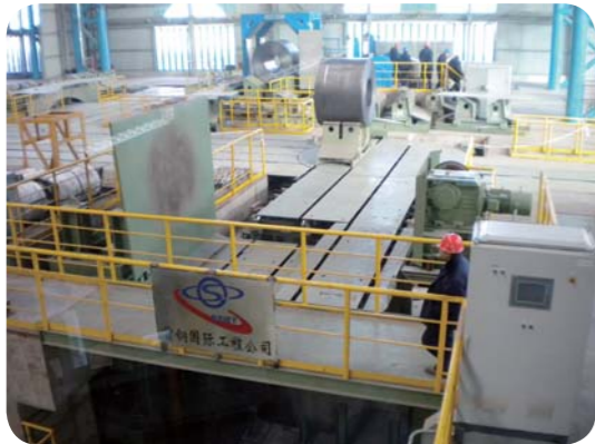
热轧双排式托盘钢卷运输系统
