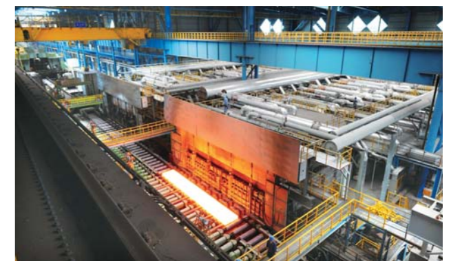
▲ 270t/h大型步进梁式加热炉
