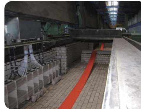
集成于酸轧联合机组的硅钢酸洗酸液加热热交换器
